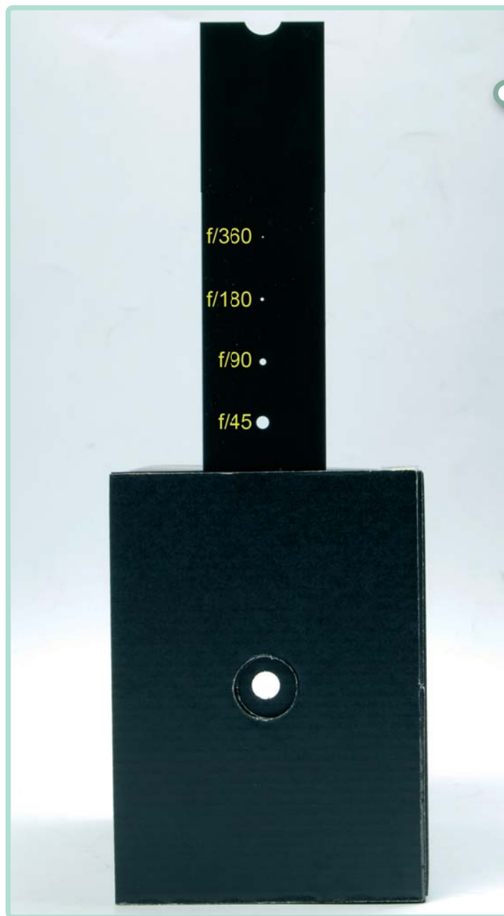
La Pinhole Camera pronta a fotografare: sono visibili sul “binario” i quattro pinhole / diaframmi selezionabili.
